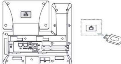
Remarque : Le port USB (derrière le téléphone) peut également être utilisé pour connecter le module d'extension à écran couleur EXP50 ou le casque USB.
