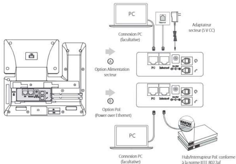
Remarque : Le téléphone IP doit seulement être utilisé avec l'alimentation Yealink (5V/1.2A) d'origine. L'utilisation d'un adaptateur secteur tiers peut endommager le téléphone. Si vous connectez un ordinateur à votre téléphone, nous vous recommandons d'utiliser le câble Ethernet fourni par Yealink.
