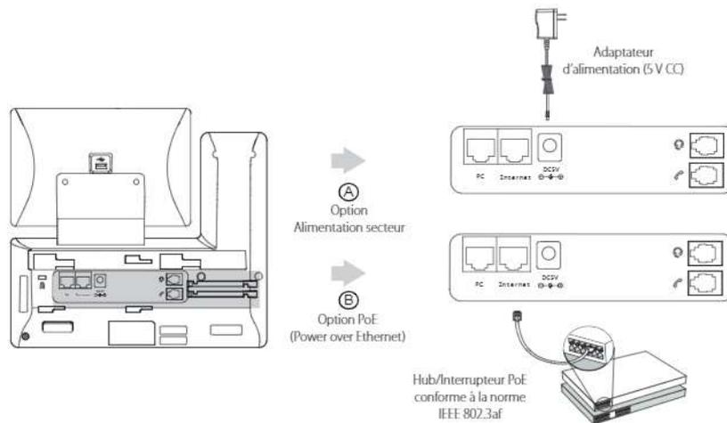
Remarque : Le téléphone IP doit uniquement être utilisé avec l'adaptateur d'alimentation Yealink (5 V/2 A). L'utilisation d'un adaptateur d'alimentation tiers est susceptible d'endommager le téléphone.
